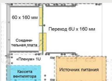
Схематическое изображение вида сбоку корзины серии VME 6023
